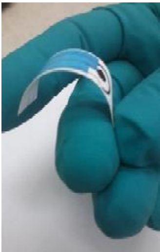
Figura 1. Structura electrodice cu 3 electrozi depusa pe support flexibil utilizata pentru determinarea concentratiei de dopamina si acid uric [1,2].
